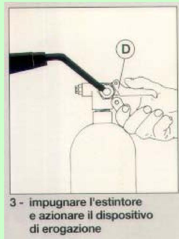
3 - impugnare l'estintore e azionare il dispositivo di erogazione
